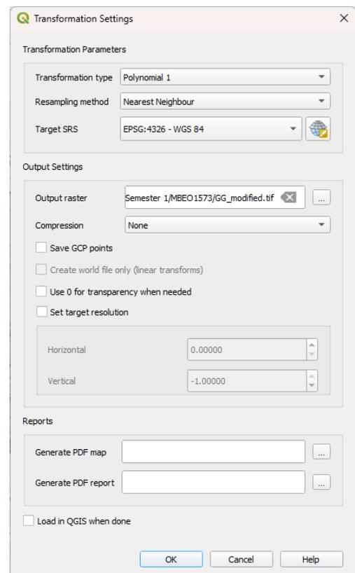
9. Tekan tombol “start georeferencing”. Pergerakan (*shifting*) dapat dilihat pada *image* setelah georeferencing dibuat. Tutupkan georeferencer.
